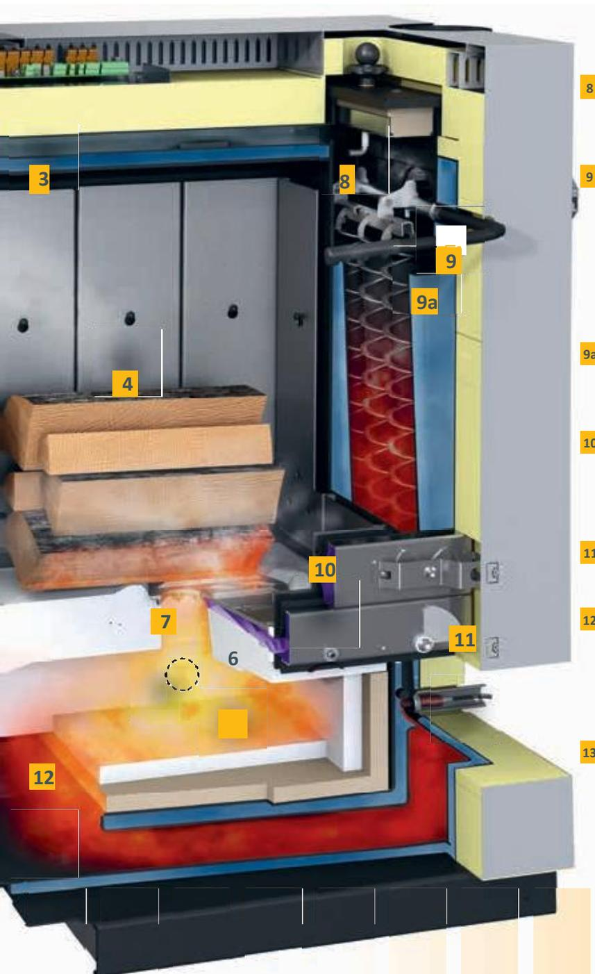
**8: ドラフトファン**：非常に静かで、このファンはボイラーの圧力の下で確実にします。さらに、空気量を制御して、ボイラー室の安全を確保します。
